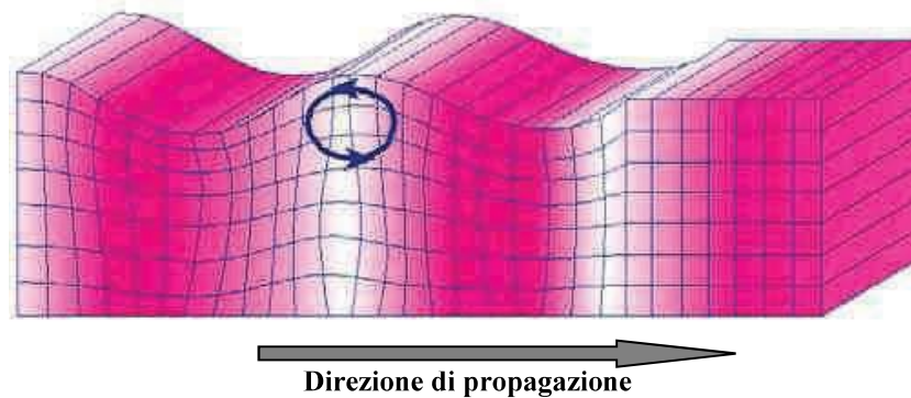
Fig. 1 - Rappresentazione grafica della propagazione delle onde superficiali di Rayleigh caratterizzata dall'oscillazione polarizzata in un piano verticale e con movimento delle particelle retrogrado rispetto al senso di propagazione dell'onda.
