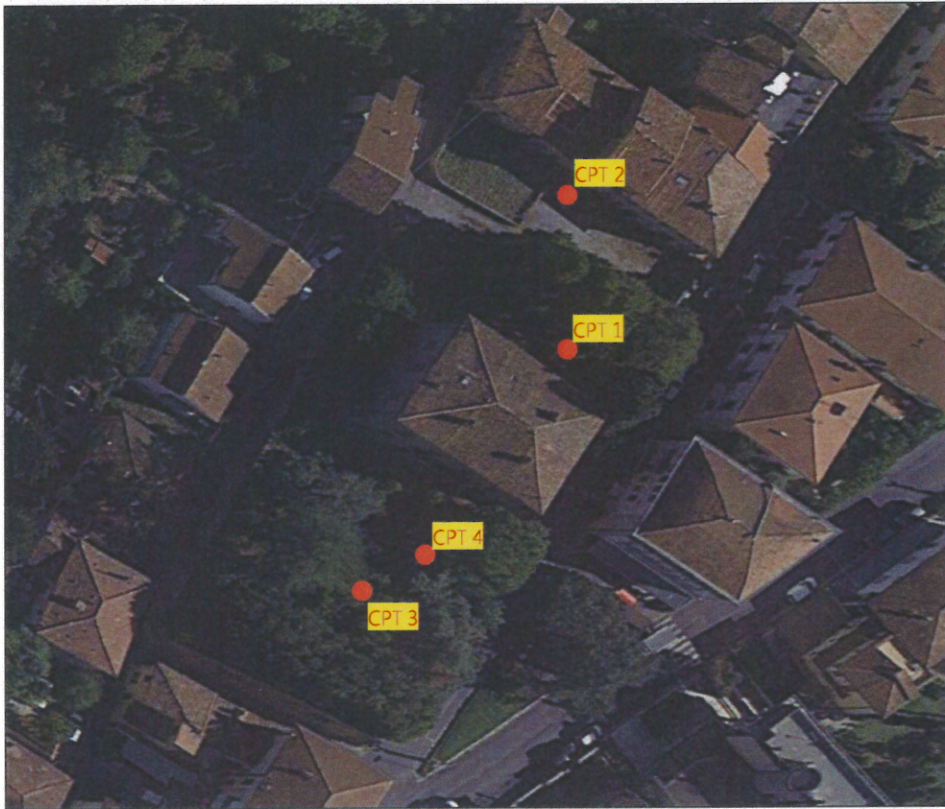
Ubicazione prove penetrometriche
