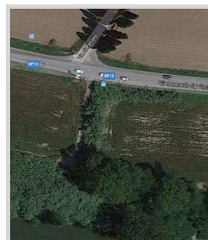
Dopo 440 m dall'intersezione con via Petroio, la fascia destra della S.P. 13 in studio non si presenta più come un terreno agricolo coltivato, ma si presenta di nuovo in quota leggermente ribassata alla strada S.P. 13 con una fascia verde solcata da un fosso di guardia con attraversamento idraulico alla S.P. 13, e perimetrante il campo di "agility dog" appartenete all'area sportiva.
