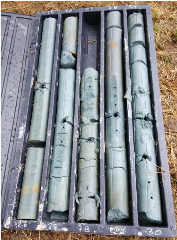
FOTO 9 Cassetta catalogatrice da m. 25,00 a m 30,00. La foto mostra la campionatura delle alluvioni sabbiose-limose talora a maggiore componente sabbiosa
