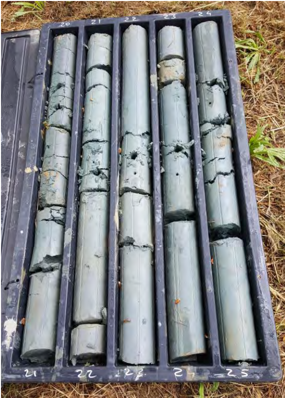
FOTO 8 Cassetta catalogatrice da m. 20,00 a m 25,00. Ancora alluvioni sabbiose-limose
