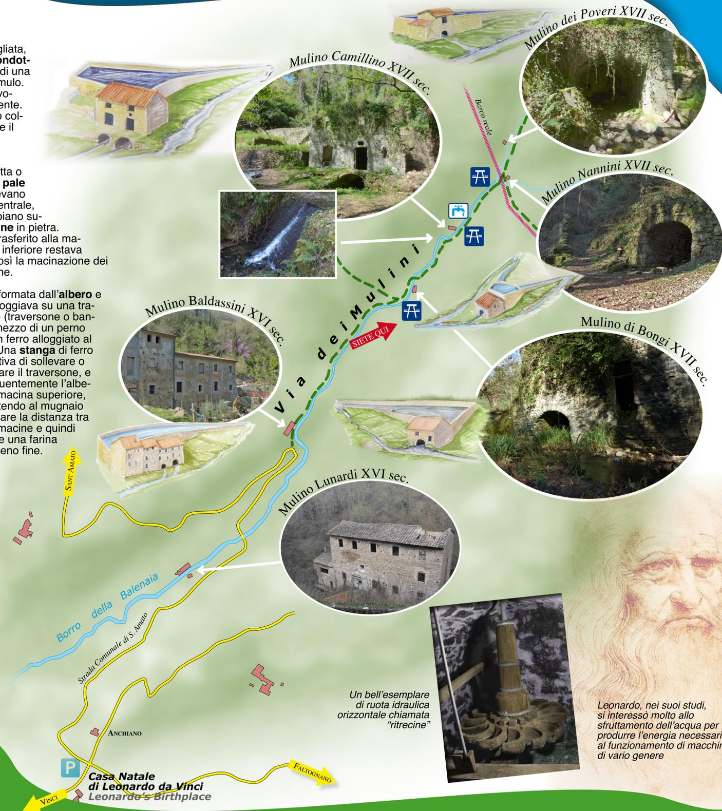
I **mulini** del Montalbano possiedono tutti caratteristiche simili, ovvero un funzionamento ad acqua con ruota idraulica orizzontale su asse verticale, collocata in un locale posto al piano semi-interrato all'interno del quale l'acqua veniva convogliata mediante un condotta forzata, detta "doccia".
