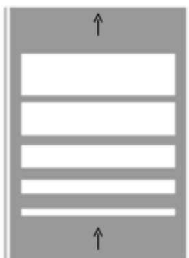
Sulla base delle indicazioni progettuali ovvero della Direzione Lavori, i sistemi di rallentamento ad **effetto acustico** saranno realizzati mediante irruvidimento della pavimentazione stradale ottenuta con la scarificazione o incisione superficiale della stessa o con l'applicazione di strati sottili di materiale in rilievo in aderenza, eventualmente integrato con dispositivi rifrangenti. Tali dispositivi possono anche determinare effetti vibratorii di limitata intensità.
